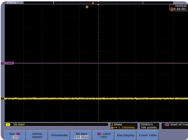
► **Figure 15.** CAN bus setup menu.
